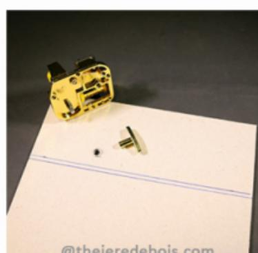
3/ Marquez ensuite, au travers des trous du mécanisme, les emplacements des clous de fixation.
